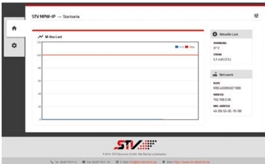
Die Weboberfläche der MPW-IP-Wandler (hier MWP16-IP) von STV Electronic bietet Diagnose- und Parametrieroptionen
