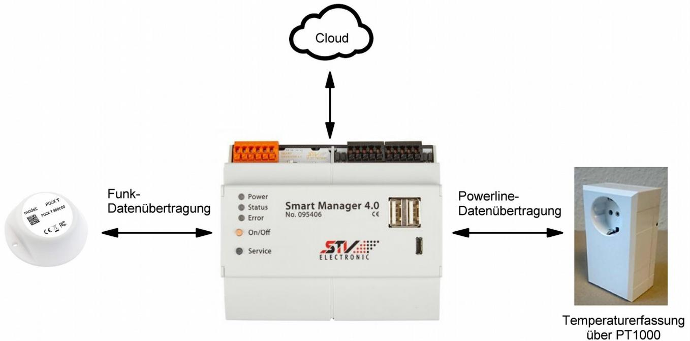
Die **Funk-Datenübertragung** der Pucks nutzt Active-RFID und **433,92 MHz**. Die integrierte **Batterie** hält bei einem Sendezyklus von 2s **zehn Jahre**. Der Zustand der Batterie ist überwacht. Durch die geringe Baugröße und das lebensmittelechte Gehäuse bieten sich die Pucks ideal zur **HACCP-konformen Temperaturüberwachung** von Lebensmitteln an. Aber auch Maschinen oder Energieverteiler können so einfach überwacht werden.
